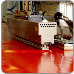
HF Schweißarbeiten high frequency application
