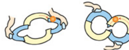
Durch den Bewegungskreislauf von Öffnen und wieder Schließen der Bahn entsteht eine Endlosschleife für die Kugel
